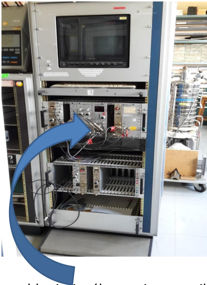
Ensemble tiroirs électroniques + vibreur WissEl avec calibration laser de la vitesse (en fonctionnement)
